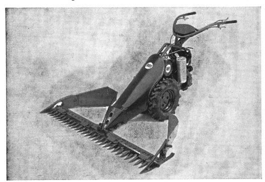
AGRIA — Spezialmotormäher mit 5 PS/200 ccm Zweitaktmotor komplett mit Gummibereifung und Mähbalken 105-140 cm Fr. 1590.—
