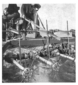
Abb. 3 Mehrreihige Anbaumaschine zum Vereinzeln von Rüben. Hersteller: S.A.C.M.A., Boulevard Péreire 90, Paris (17e).
