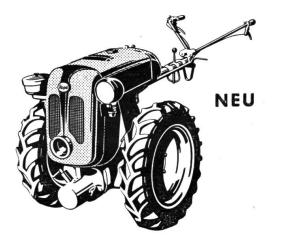
Nun auch in Spezialausführung als Typ S-SUPER erhältlich. Ideale Universalmaschine für Kleinbetriebe. Für Traktorenbetriebe zum Mähen, Eingrasen, Hacken, Häufeln und Eggen. 9 PS 4-Takt-Motor mit Regulator, 4 Vorwärtsund 2 Rückwärtsgänge, 2 Zapfwellen, Bremse, Differential mit Sperre, Räder in Höhe und Breite verstellbar, erschütterungsfreier Messerantrieb, Mähbalken 160 und 190 cm.
