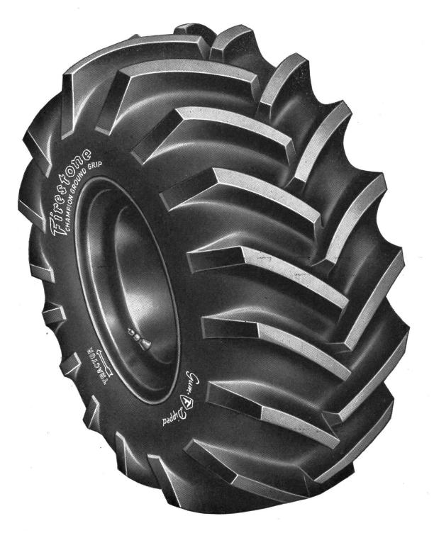
Die Profilstollen : konisch. Sie fassen das Erc tiefer in dasselb
