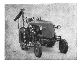
Kräftiger, sparsamer, luftgekühlter 12 PS-Motor. 6-Gang-Getriebe. Differential mit Sperre. Radspur vorn und hinten verstellbar. Automatische Einzelradabbremsung beim Wenden. Kipp-System, d. h. Verlagerung des Gewichtes auf die Hinterachse zur Erhöhung des Bodenhaltes. Wendig, handlich.
