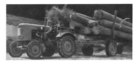
Abb. 10 Vorderwagen mit Triebachse für Langholzwagen
