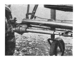
Abb. 5: Ein Zapfwellenantrieb mit Doppelgelenk
