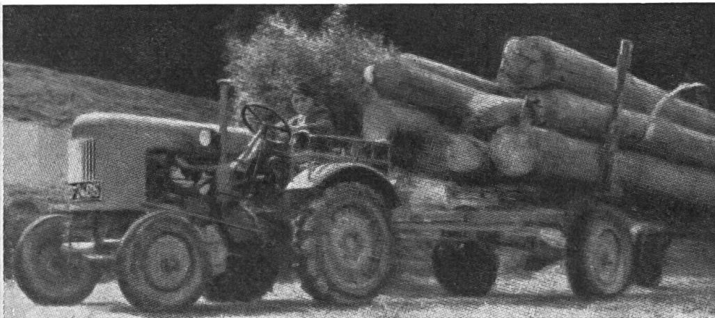
Abb. 10 Vorderwagen mit Triebachse für Langholzwagen
