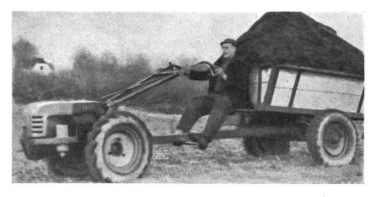
Abb. 3 Einachsschlepper mit Triebachswagen
