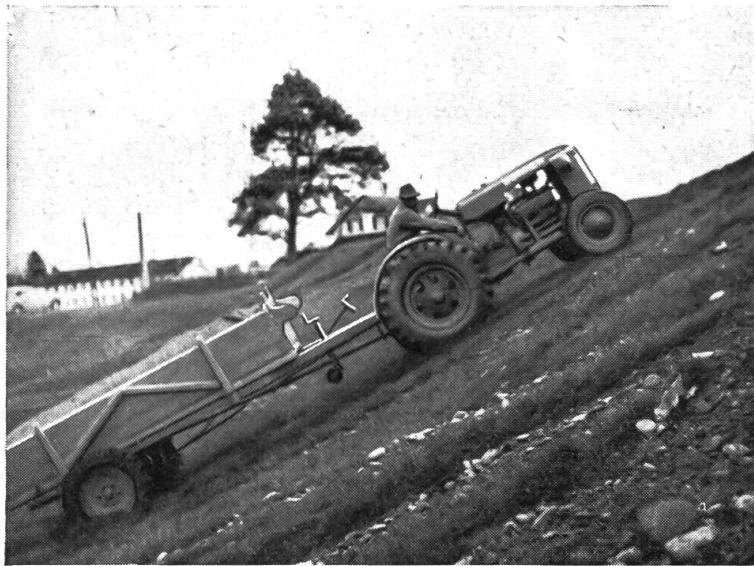
Dieser **Triebachs-Anhänger** ersetzt eine schwerfällige, hochpferdige Zugmaschine. Er überwindet mit 3 t Belastung, mit einem 8-PS-Traktor, Steigungen bis zu 40 %!
