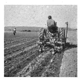
Abb. 1b: Zudecken und Häufeln mit 4-reihigem Traktoranbauvielfachgerät.
