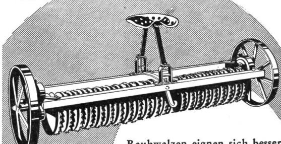
Rauhwalzen eignen sich besser für den Ackerbau als Glattwalzen. Patentierte Fahrvorrichtung. — Für Pferde- und Traktorzug. 2 m Arbeitsbreite. Vom IMA geprüft.
