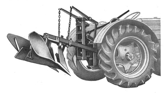
Spezielles Modell mit Sicherheitsbolzen und Handaufzugs-Hebevorrichtung zu vorteilhaftem Preis
