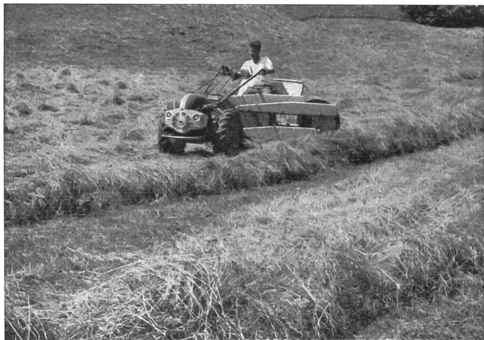
Zapfwellen-Schwadenerrechen an einem Einachs-Traktor. Beim Verrichten dieser Arbeit bezahlt der Bauer **Fr. 26.50** je 100 kg Benzin in die Staatskasse, resp. an den Unterhalt der Strasse !
