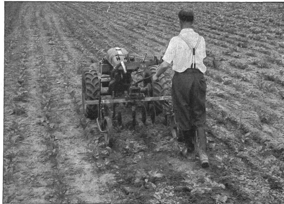
Hacken einer Zuckerrübenkultur mit einem Hackgerät an einem Einachs-Traktor. Beim Verrichten dieser Arbeit bezahlt der Bauer **Fr. 26.50** je 100 kg Benzin in die Staatskasse, resp. an den Unterhalt der Strassen !
