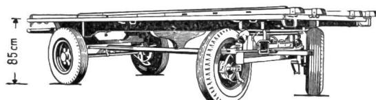
Pat. Nr. 256 992 mit fester Vorderachse, Achsschenkellenkung mit ganzem Rank von 90 Grad, erstklassige Klemmbackenbremsen auf 2 oder 4 Räder, Unterwagen Stahlkonstruktion; neuartige Brücke, niedere Bauart, Serienfabrikation, daher normalisierte Teile und niedere Preise. Für Holztransporte in den Bergen extra niedrig gebaut. Für motorisierten Zug elektrische Bremsen.
