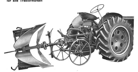
Spezielles Modell mit Sicherheitsbolzen und Handaufzugs-Hebevorrichtung
