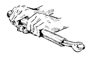
Schrauben unter  $^{1}/_{2}$   $^{\prime\prime}$  (12 mm) Gewindedurchmesser dürfen auf keinen Fall mit Schlüsselverstärkung festgezogen werden!
