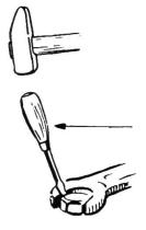
Ein zwischen Kopf und Schlüssel gekeilter Schraubenzieher dagegen beschädigt beide Teile.
