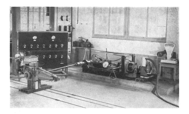
Ansicht des Motorenbremsstandes für Einachstraktoren und Motormäher Strickhof/Zürich. Links hinten erfolgt der Anschluss an die Radnabe, rechts vorne der direkte Anschluss an den Motor.
