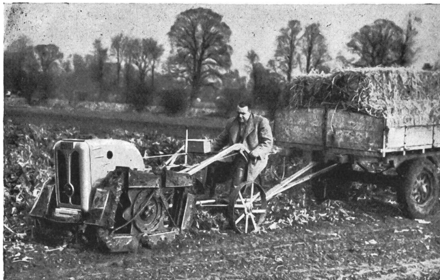
Abb. 4: Einachs-Schlepper mit Raupe zieht Anhänger.
