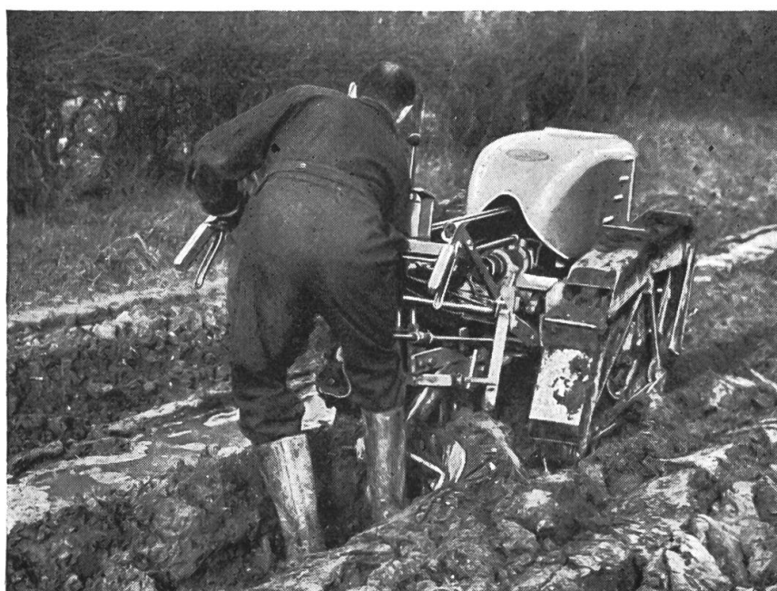
Abb. 5: Einachs-Schlepper beim Tiefpflügen.
