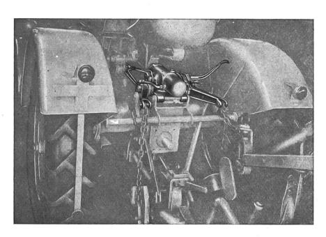
Der hydraulische Kraftheber für Einbau in jeden Traktor gleich welcher Marke und Typ, wenn auch keinen Zapfwellen-Antrieb.
