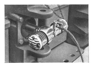
Allgemeine Beurteilung: Die Zapfwellenluftpumpe «Mammut» hat sich bei der praktischen Verwendung bewährt. Es lassen sich mit ihr alle Fahrzeugpneus in kurzer Zeit aufpumpen. Die Pumpe ist in der Bedienung und Wartung sehr einfach.
