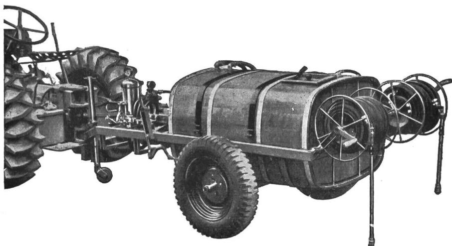
Motorpumpe angetrieben durch Traktor mittels Cardanwelle
