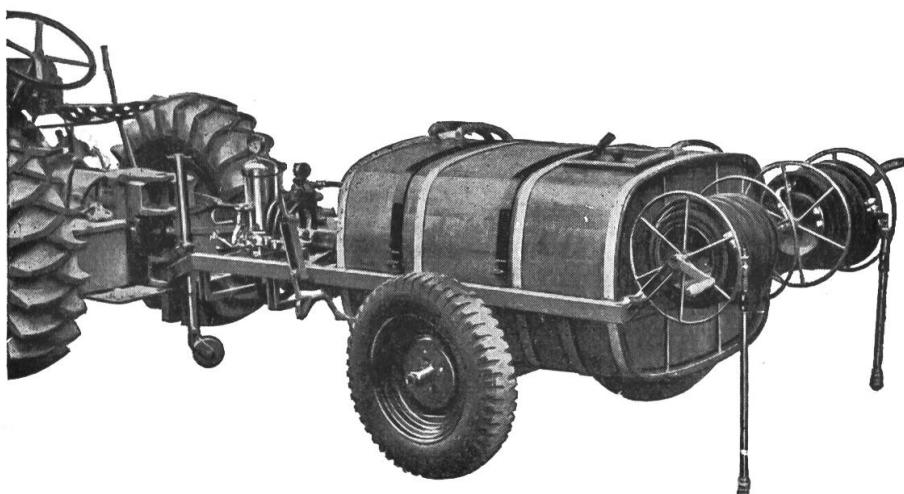
Motorpumpe angetrieben durch Traktor mittels Cardanwelle
