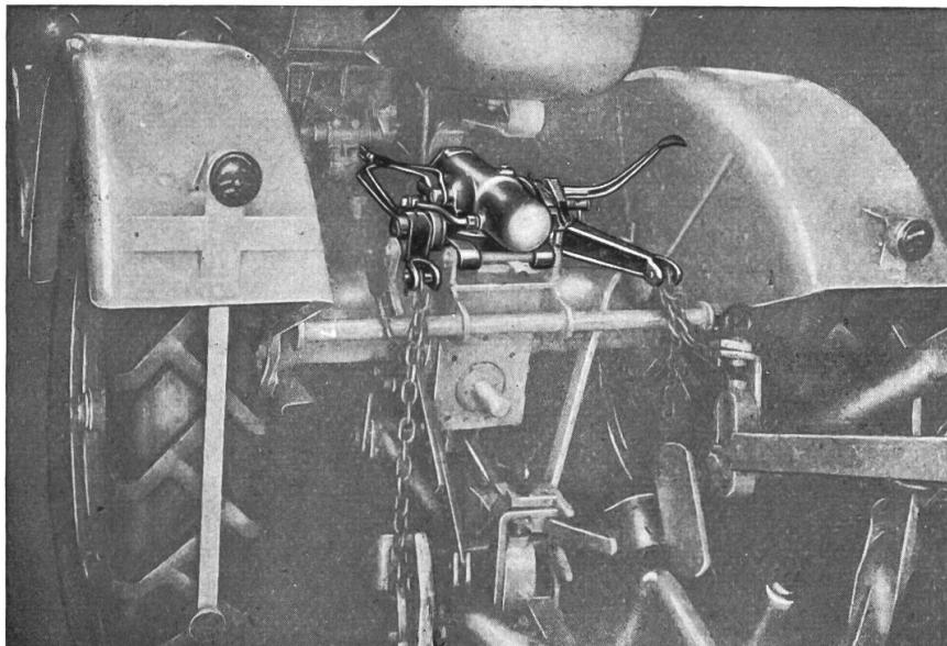
Der hydraulische Kraftheber für Einbau in jeden Traktor gleich welcher Marke und Typ, wenn auch keinen Zapfwellen-Antrieb.
