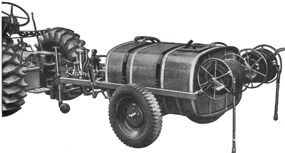
Motorpumpe angetrieben durch Traktor mittels Cardanwelle
