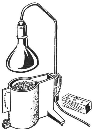
**Allgemeine Beurteilung:** Der Feuchtigkeitsmesser AGAT X 14 zur Bestimmung des Feuchtigkeitsgrades des Getreides und ähnlicher Produkte ist leicht, handlich und von einfacherem Aufbau. Er gestattet, in jedem Gebäude mit Lichtanschluss rasch den Feuchtigkeitsgrad des Getreides zu bestimmen. Dies wird u. a. vor allem beim Mähdurst der Fall sein. Der Apparat kann an den Lichtstrom angeschlossen werden und ist leicht zu bedienen.
