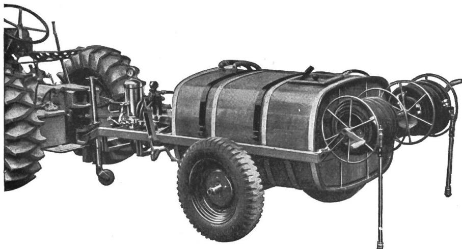
Motorpumpe angetrieben durch Traktor mittels Cardanwelle
