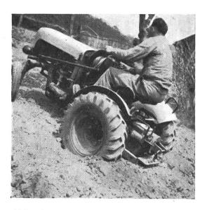
Abb. 6a: Der Traktor hat sich beim Direktzug im Hang eingegraben . . . .
