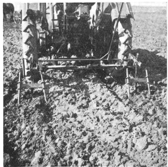
Abb. 3: Aufreissen der Radspuren mit zweckmässig konstruiertem Spurlockerer.
