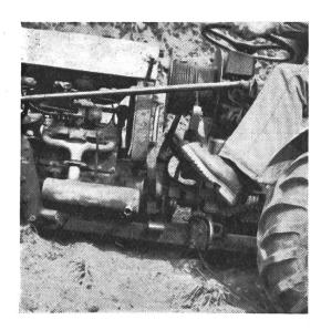
Abb. 4b: Die sog. Spillwinde als Anbauwinde von der Seite gesehen.
