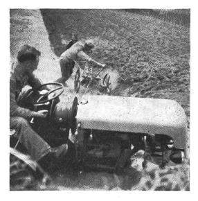
Abb. 4a: Direkter Seilzug quer zum Traktor.
