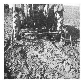
Abb. 3: Aufreissen der Radspuren mit zweckmässig konstruiertem Spurlockerer.
