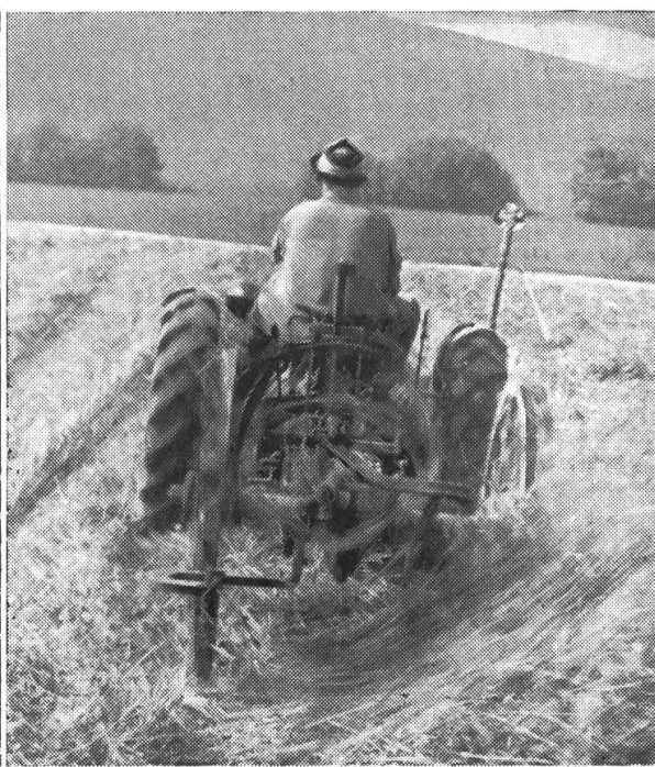
Abb. 2: Der Kartoffelgraber bei der Zettarbeit
