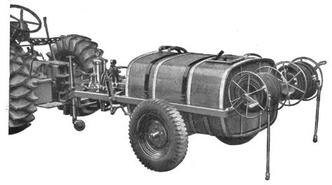
Motorpumpe ångetrieben durch Traktor mittels Cardanwelle Behälterwagen von 300—800 I Inhalt
