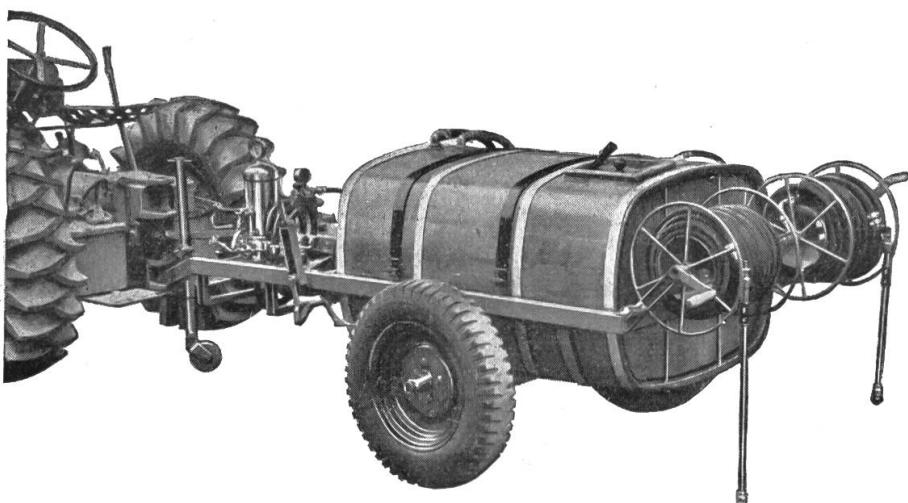
Motorpumpe angetrieben durch Traktor mittels Cardanwelle
