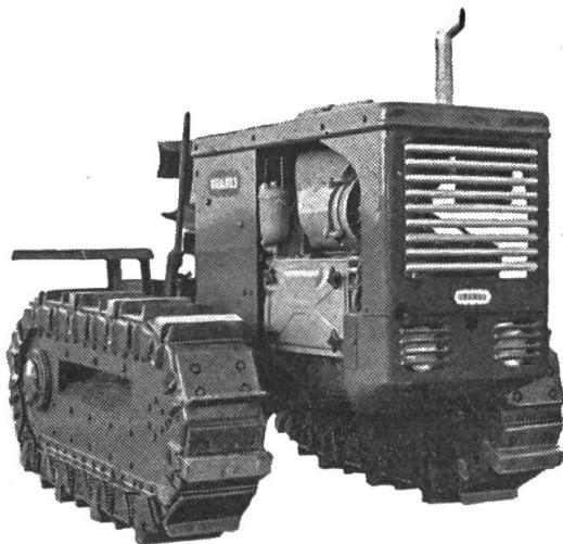
*Wissen Sie* dass der Raupentraktor eine sehr geringe Bodenpressung hat? Daher schont er den Boden, kommt überall durch und zieht auch viel auf schlechtem Boden.
