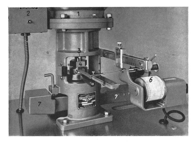
Abb. 7: Vierkugelapparat zur Prüfung von Schmiermitteln auf Schmierfähigkeit, bzw. Hochdruckeigenschaften.
