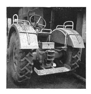
Abb. 2 Traktor mit Hilfssitzen nach deutschem Vorbild.
