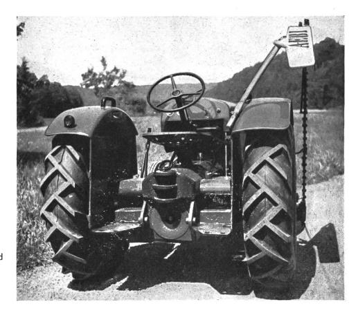
Abb. 3 Traktor mit Haltegriffen und Innenwand unterhalb der Kotflügel.
