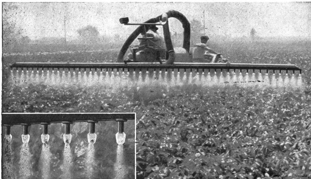
Abb. 7a: Berthoud-Nebelblaser mit Spritzbarren von 6 m Breite, 50 Düsen (Strahler) für Flüssigkeit oder Staub für Feldkulturen, umstellbar auf Obstbau.
