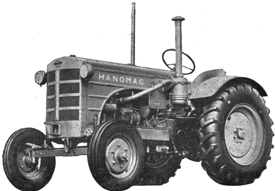
**HANOMAG-Diesel-Traktoren, 16, 22 und 28 PS, 5 Vorwärtsgänge**
