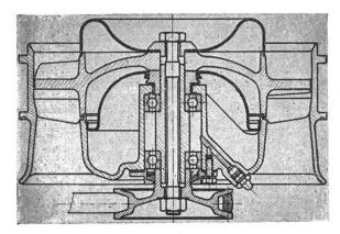
Bild 2: Schnitt durch das Kühlluftgebläse.
