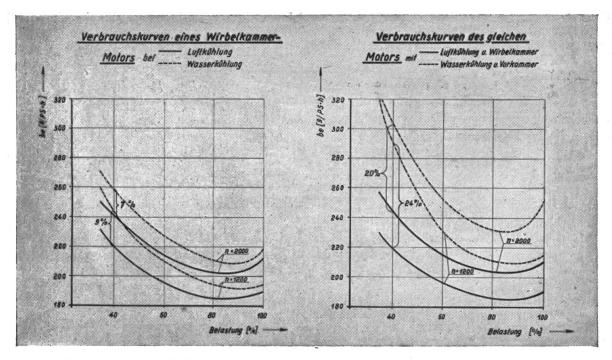
Bild 8: Brennstoff-Verbrauchskurven von luft- und wassergekühlten Motoren.
