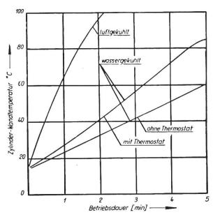
Bild 7: Zylinderwandtemperatur nach dem Start von luftgekühlten und wassergekühlten Motoren bei Normalbelastung und Aussentemperatur plus 180 C.
