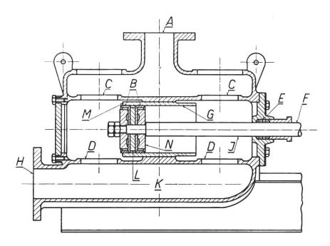
Fig. 4: Liegende Kolbenpumpe.
