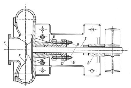
Fig. 2: Zentrifugalpumpe
