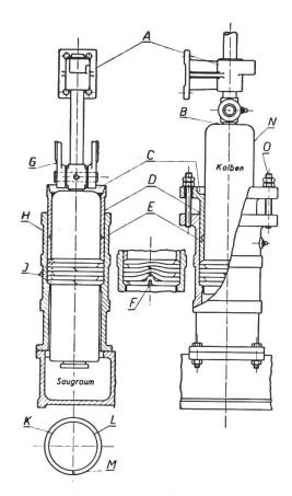
Fig. 3: Stehende Kolbenpumpe
