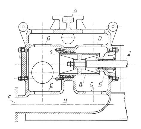
Fig. 5: Liegende Kolbenpumpe. Neuzeitliche Kolbenkonstruktion bei liegenden Pumpen ohne Zylinder, im Oelbad laufend.
