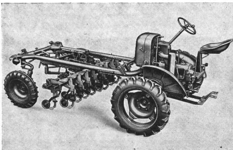
Einige technische Daten des Lanz-Motor-Gerätträgers: 12 PS-Motor; 5 Vorwärtsgänge, 1 Rückwärtsgang; mögliche Geschwindigkeiten von 2,57 bis 19,0 km/h.; 2 Zapfwellen, getrennt schaltbar, 540 Umdr./min.;
