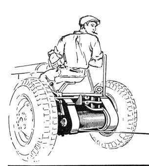
Anschluss an Zapfwelle
