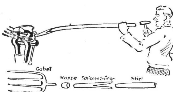
aus dem alten Stiel herausgeschlagen. Vorher hat man sich beim Eisenwarenhändler oder Wagner einen passenden Gabelstiel mit vorgebohrtem Loch und dazu eine Schienenzwinge mit Kappe beschafft. Nun werden die Schienenzwinge und Kappe, wie im Bild dargestellt, nacheinander auf den Stiel geschoben und leicht eingetrieben, bis sie sitzen. Zum Schluss wird der Stiel der Gabel in die Bohrung eingeführt und leicht festgeklopft. Alsdann prüfen
