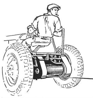
Anschluss an Zapfwelle
