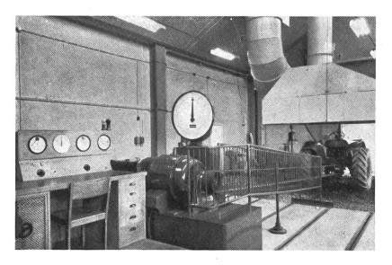
Abb. 4: Bremsstand für Traktoren.
