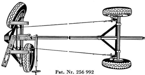
Pat. Nr. 256 992 mit fester Vorderachse, Achsschenkellenkung mit ganzem Rank von 90 Grad; erstklassige Klemmbackenbremsen auf 2 oder 4 Räder, Unterwagen Stahlkonstruktion; neuartige Brücke; niedere Bauart. Serienfabrikation, daher normalisierte Teile u. niedere Preise.
