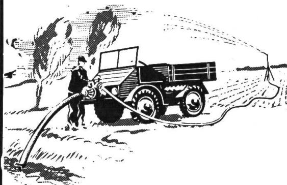
Die von der vorderen Zapfwelle angetriebene Pumpe fördert 800 min/lt.
