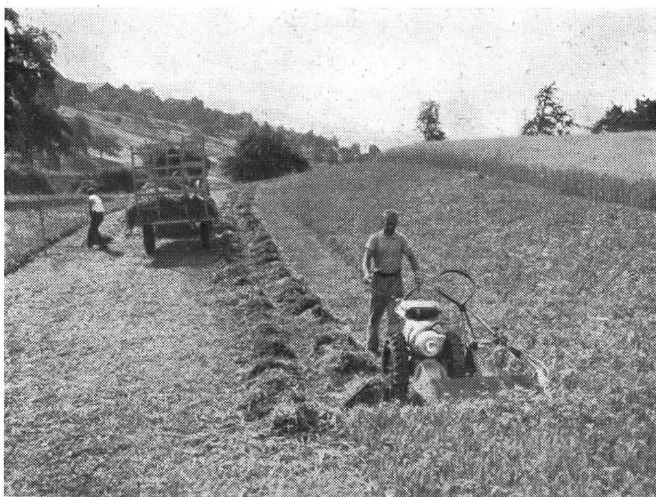
**Allgemeine Beurteilung:** Das Eingrasen lässt sich mit Hilfe des Schwadenformers zum Einachstraktor Rapid S wesentlich erleichtern. Bei Mähflächen von mindestens 5 Aren kann — verglichen mit der Handarbeitsmethode — der Arbeitsaufwand auf nahezu die Hälfte reduziert werden.
