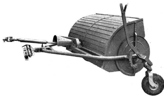
anbaubar an alle Fahrzeuge mit normalisierter Zapfwellen, seitlich oder zentral, für linkes oder rechtes Mähwerk.
