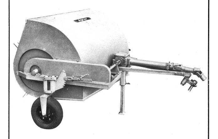
eignet sich zum Anschluss an alle Traktoren mit normalisierter Zapfwelle.
