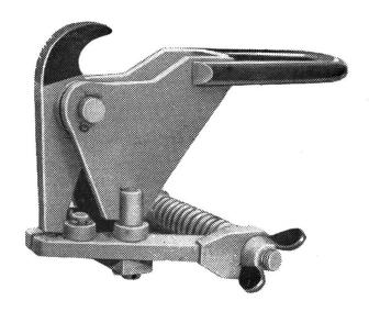
Vorteil der geringen Baulänge und des kleinen Gewichtes. Die Auslösekraft kann anhand der Gebrauchsanweisung durch das Zählen der Schraubenumdrehungen von 170 kg bis 940 kg eingestellt werden.
