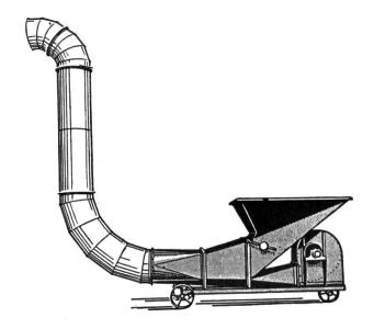
Allgemeine Beurteilung: Das Heu- und Garbengebläse Zumstein eignet sich für den Transport von Heu und Emd, für Hand- und Maschinengarben und für kleine Strohballen. In 20—30 Minuten kann ein Fuder Heu, Emd oder Garben von 1600—2000 kg abgeladen werden. Anlagen mit Förderrohren von 500 mm Durchmesser benötigen folgende Antriebsleistungen:
