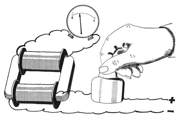
Fig. 89: Wenn zwei Spulen auf denselben Eisenkern gewickelt sind, so fliesst in der zweiten ein Strom, wenn in der ersten der Strom ein- und ausgeschaltet wird. Dieses Gesetz wird nicht nur im Zündmagneten, sondern auch in allen Transformern ausgenützt. Im Zündmagnet wird der Primärstrom mit niederer Spannung auf die Zündspannung hinauftransformiert.
