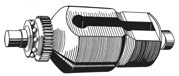
Fig. 90: Umlaufender Magnet eines «Scintilla»-Magnets. Das Zahnrad ist für den Verteilerantrieb vorgesehen. Am Ende ist der Nocken für die Unterbrecherbewegung angeschraubt.
