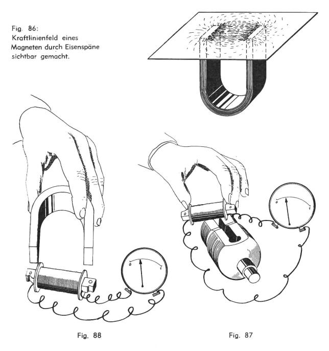
Fig. 87: Elektrischer Strom wird erzeugt, indem eine Spule durch ein magnetisches Feld bewegt wird («Bosch»).
