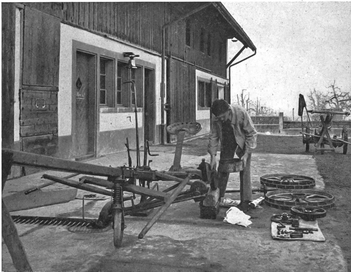
Gründliche Reinigung und Revision einer Mähmaschine am Strickhof/Zürich
