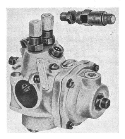
**Bosch-Benzin-Einspritzpumpe.**Oben querliegend Einspritzdüse.
