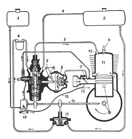
Schematische Darstellung des Benzineinspritzaggregates von Bosch, wie es von den zwei deutschen Fahrzeugfabriken Gutbrod und Goliath für ihre Zweizylinder-Zweitaktmotoren verwendet wird.
