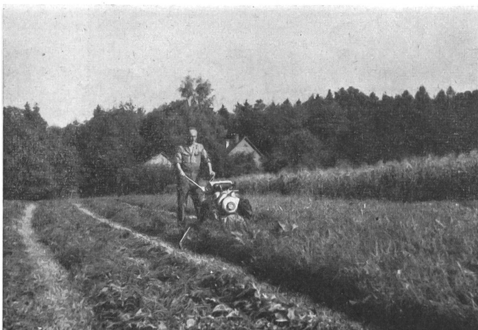
Abb. 5: Rapid-Einachs- traktor beim Mähen.
