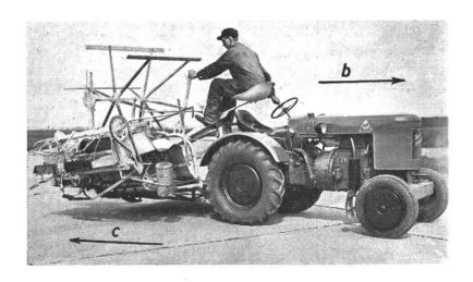
**Abb. 2:** Anordnung des Frontbinders auf einem rückwärtsfahrenden Normal-Schlepper (20 PS). b = Transport. c = Arbeit
