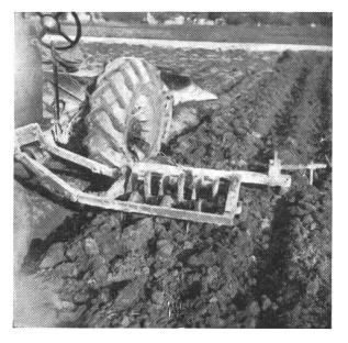
Abb. 6: Mit einer beidseitig angebrachten Spatenrollegge kann bei viermaligem Ueberfahren in der Regel eine gute Bodenstruktur erreicht werden.
