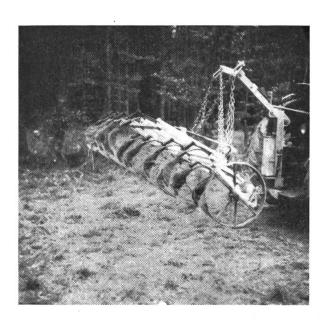
Abb. 7: Angehängter Kultivator mit hydraulischer Hebevarrichtung (hochziehbar).
