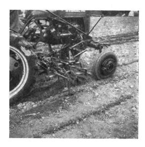
Abb. 8 a: Abb. 8 b: Hackgeräte für Einmannbetrieb zwischen der Vorder- und Hinterachse angeordnet.
