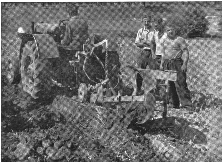
Abb. 1 a Anbaupflug mit Bruchsicherung
