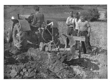
Abb. 1 a Anbaupflug mit Bruchsicherung
