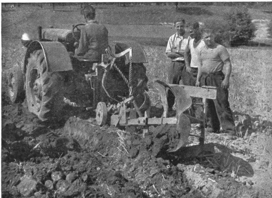
Abb. 1 a Anbaupflug mit Bruchsicherung
