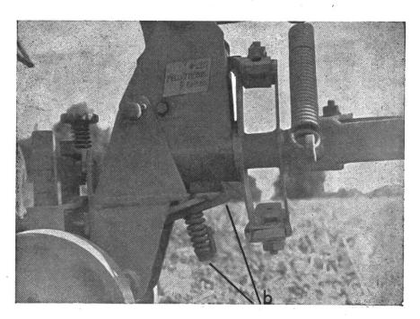
**Abb. 1 b**Detail einer Sicherheitsausklinkvorrichtung
