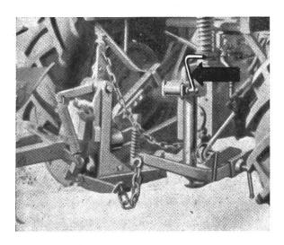
**Abb. 3**Anbaupflug mit Seitenverstellvorrichtun**g**
