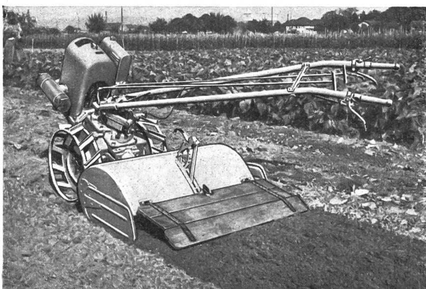
Es sollen am Frässchwanz tief herabreichende seitliche Schutzbleche und ein hinterer Schutzdeckel (siehe Abb.) vorhanden sein. Nach dem Auswechseln oder Reparieren von Fräskrallen sind die Schutzbleche unbedingt wiederum anzubringen.
