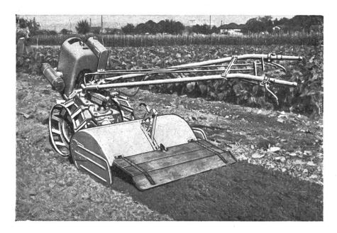
Es sollen am Frässchwanz tief herabreichende seitliche Schutzbleche und ein hinterer Schutzdeckel (siehe Abb.) vorhanden sein. Nach dem Auswechseln oder Reparieren von Fräskrallen sind die Schutzbleche unbedingt wiederum anzubringen.
