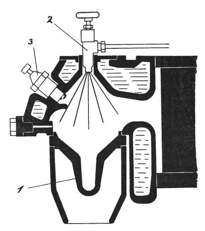
Fig. 11: Glühkopfzündung. Eine ungekühlte Partie des Zylinderkopfes erwärmt sich im Betrieb so stark, dass sich der eingespritzte Treibstoff daran entzündet.
