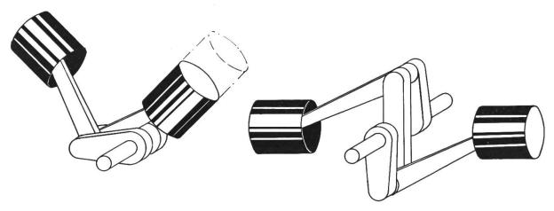
Fig. 5: 2-Zylinder V-Motor.
