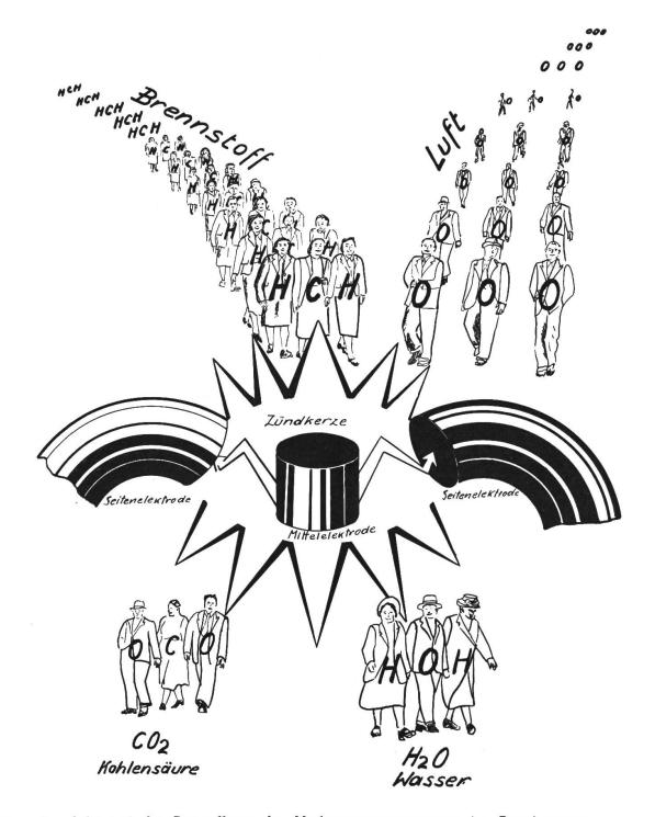
Fig. 2: Schematische Darstellung des Verbrennungsvorganges im Benzinmotor.
