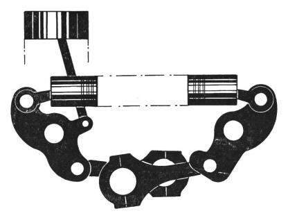
Fig. 7: Gegenkolbenmotor mit liegendem Zylinder (Mägerle, Sulzer).
