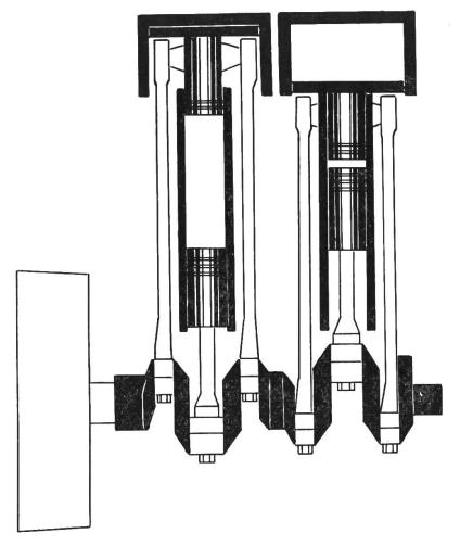
Fig. 8: Gegenkolbenmotor mit stehendem Zylinder (Junkers, CLM).
