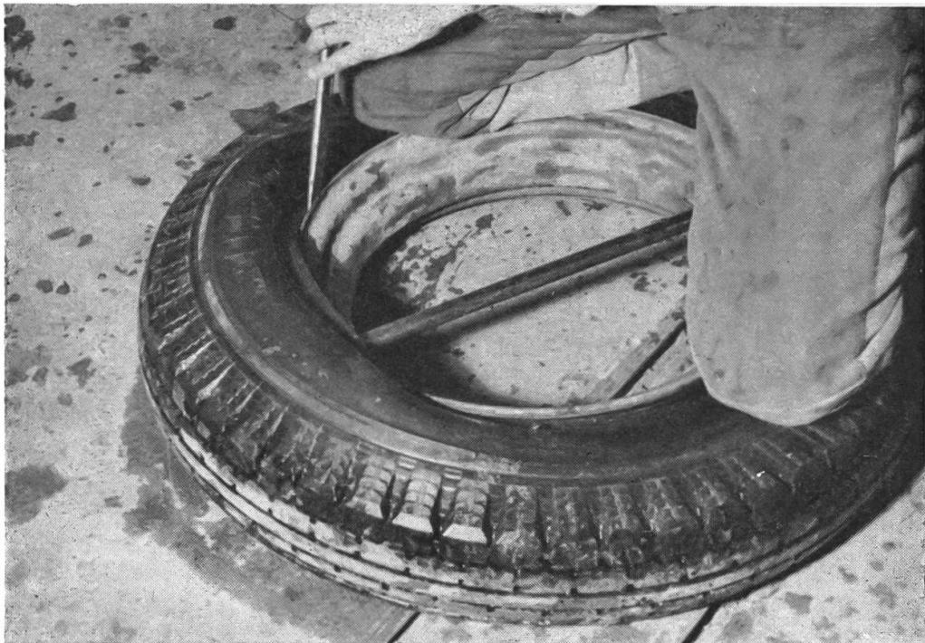
Tiefhalten des Pneus durch aufknien gegenüber dem Ventil und Anheben des Pneus auf der Ventilseite mittels 2 Pneuheber. Im Verlaufe der weiteren Demontage soll nur kurz nachgefasst werden.
