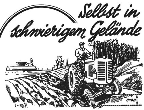
ist der Renault-Traktor 22/30 PS mit seiner gelenkig gelagerten Vorderachse unbedingt standfest, d.h. alle vier Räder berühren trotz Unebenheiten den Boden.
