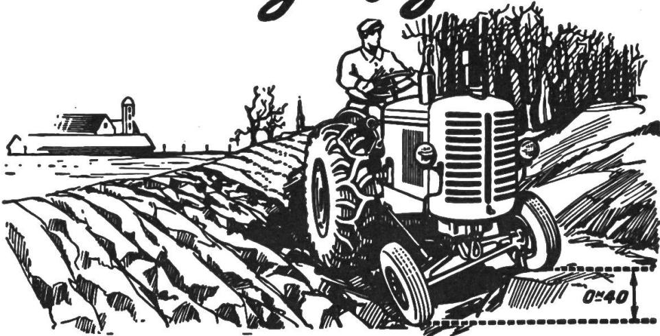
ist der Renault-Traktor 22/30 PS mit seiner gelenkig gelagerten Vorderachse unbedingt **standfest**, d.h. alle vier Räder berühren trotz Unebenheiten den Boden.
